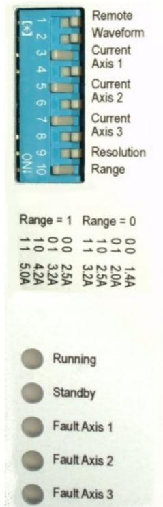
Schalter Nr. 10 dient der groben Auswahl des Motorstrombereichs für alle Achsen gleichzeitig. Ein gleichzeitiger Betrieb von sehr kleinen und sehr großen Motoren ist somit nicht möglich. Je nach gewähltem Bereich kann dann die Feineinstellung für jeden Motor getrennt mit den Schaltern 2..8 vorgenommen werden.
