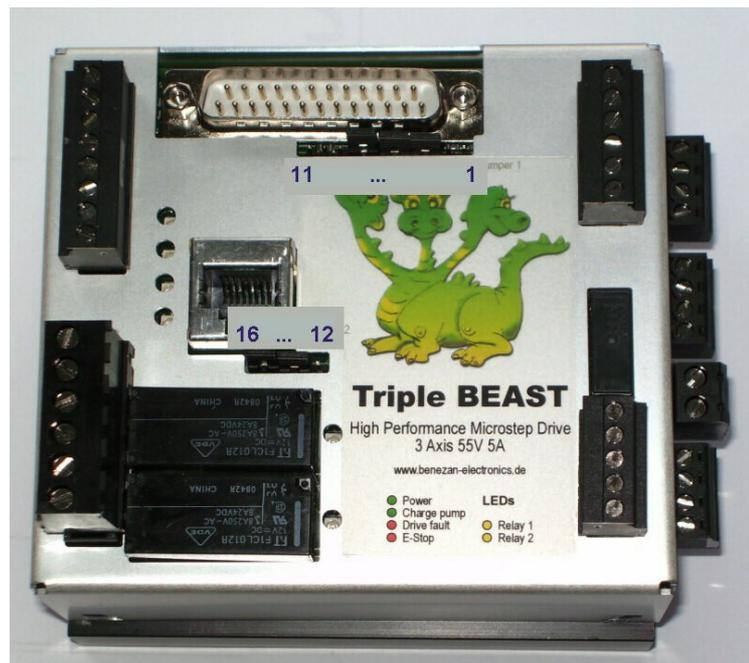
(16..12) Diese Jumper dienen der Einstellung der Versorgungsspannung für die Endschalter und der Freigabe der vierten Achse (siehe unten)
